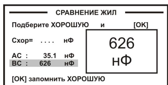
Прибор проведет измерение емкости жилы, которая принимается за эталонную и сравнивает с ней емкость оборванной жилы. На приведенном рисунке хорошая жила В имеет емкость по отношению к оболочке 626 нФ. Прибор показал, что он выбрал ее за эталон «С хор» и сравнил с ней емкость оборванной жилы А. Результат показан в процентах длины или метрах, если длина введена.
