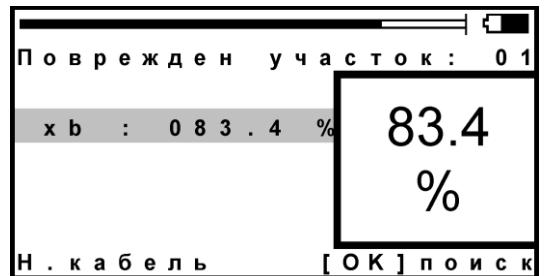
Если неисправная жила диаметром больше 1,2 мм, то измерительный провод В может внести дополнительную погрешность. Чтобы проверить это, подключите провод С к началу неисправной жилы, куда подключен В. Повторите последнее измерение, нажав кнопку [OK]. Если результат отличен от 0, то его надо вычесть из полученного расстояния до дефекта.
