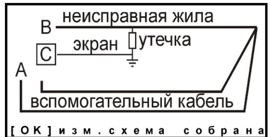
Измерительный провод С отсоедините от вспомогательной жилы и подсоедините к экрану кабеля. Нажмите кнопку [OK]. Прибор покажет расстояние до повреждения неисправного кабеля в процентах длины для неизвестного кабеля или в метрах, если длина введена.
