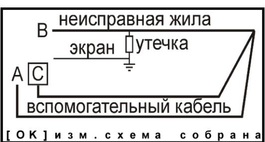
Сначала прибор измерит сопротивление между проводом А и В, то есть сопротивление неисправной жилы и подключенной вспомогательной. Этот результат будет выведен на экран: Rab. Само по себе это значение не нужно, но позволяет контролировать правильность подключения. Затем прибор закончит первый этап измерений и покажет сопротивление плохой жилы "R жилы", подаст сигнал и покажет, что провод С следует подключить к экрану кабеля (земле).
