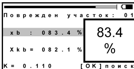
Полученное значение прибор корректирует с помощью коэффициента K, хранящегося в памяти прибора. Измеритель может сравнить расстояние по Купфмюллеру Xkb с расстоянием Xb. Если они разнятся (как в приведенном примере), и у измерителя есть уверенность, что все жилы повреждены в одном месте, он должен воспользоваться результатом Xkb, памятуя об ограничениях из таблицы.
