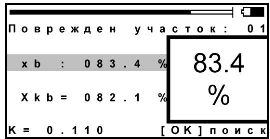
Внимание! На экран выводится результат Xk с поправочным коэффициентом для симметричных кабелей связи. Результат появляется, если в режиме ИЗОЛЯЦИЯ измерен коэффициент K. Для силовых кабелей этого не требуется.
